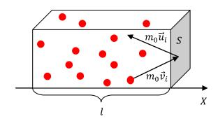
Сначала рассмотрим удар одной молекулы о стенку сосуда, считая его абсолютно упругим. Такое предположение оправдано. При неупругом ударе шаров их механическая энергий переходит в энергию молекул, а в нашем случае шарами являются сами молекулы и переходить уже особо некуда... Закон сохранения импульса:
